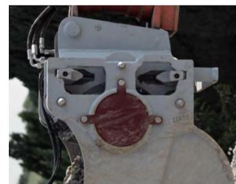
Graben und Verfüllen: Verriegelungskeile sind ausgefahren und sichern den Formschluss zum Grabgefäß
