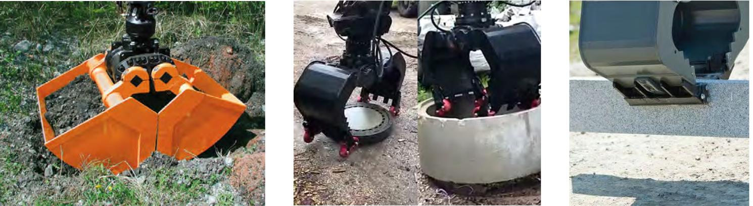
HPX Greifer von Kinshofer zeichnen sich durch ihre kompakte Bauform, konstante Schließkraft und nahezu wartungsfreien Einsatz aus. Das Drehmoment wird durch zwei gegenläufige Kolben mit vier Helixgewinden, auf zwei Wellen übertragen. Die Greiferschalen sind an diesen Wellen per Klemmverbindung befestigt und können bei Bedarf schnell und einfach gewechselt werden.
