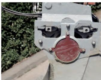
Verdichten: Verriegelungskeile sind eingefahren und erlauben freie Schwingung des Löffels
