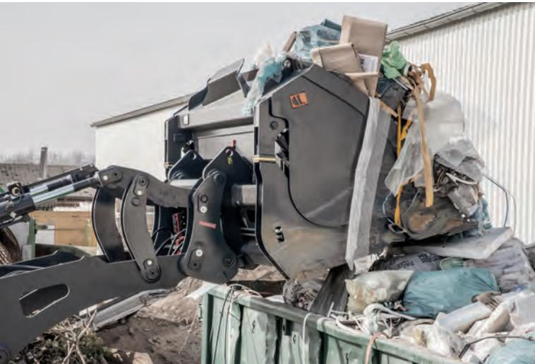
Verlegung der Hydraulikschläuche geschützt und optimal geführt.
