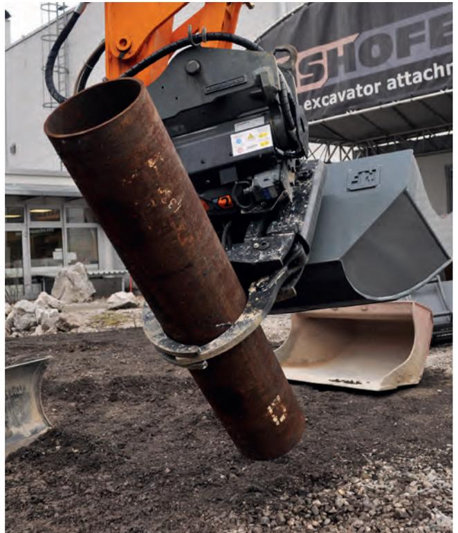
Kinshofer NOX Schwenkrotatoren sind speziell für Einsätze mit eingeschränkter Bewegungsfreiheit konzipiert. Die Schwenkfunktion erfolgt durch einen Schneckenantrieb, mit konstanter Geschwindigkeit und kontinuierlichem Antriebsmoment. Das ermöglicht besonders feinfühliges Arbeiten. Das vollständig geschlossene Gehäuse ist sehr kompakt und für Arbeiten in schmalen Gräben ideal.
