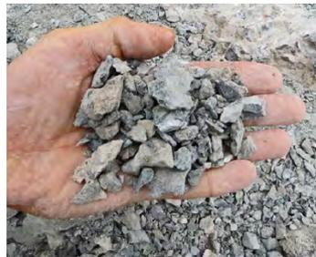
Fräsgut einer Rockwheel - kann direkt wiederverfüllt werden
