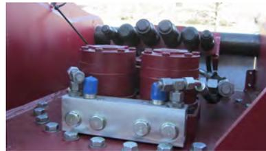
Demarec Sortiergreifer mit integriertem OilQuick Adapter: der Werkzeugadapter wird direkt am Drehkranz montiert, mit Hydraulikanschluss nach Innen. Gleichzeitig wird das Gerät kompakter = reduzierte Gesamthöhe des Greifers.
