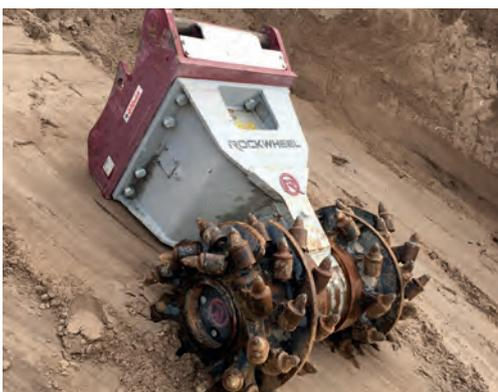
Rockwheel Fräse mit innenliegendem Hydraulikanschluss: Öffnungen in der Grundplatte des Schraubadapters erlauben den direkten Anschluss an den Fräsantrieb. Keine überstehenden Hydraulikschläuche bei Abbrucharbeiten oder in Gräben.
