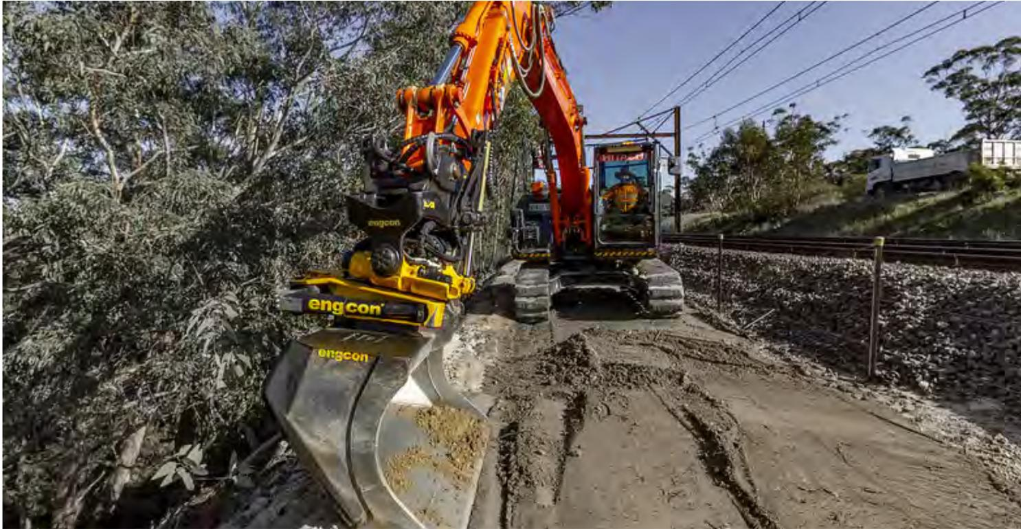
Engcon ist weltweit führender Anbieter für Schwenkrotatoren. Ausgestattet mit Schwenkzylindern sind diese Geräte besonders stark, wenn es um Grabarbeiten außerhalb der regulären Arbeitsrichtung des Baggers geht. Lasthalteventile an den Schwenkzylindern sorgen für maximale Sicherheit und die gehärteten Kolbenstangen garantieren eine lange Lebensdauer.
