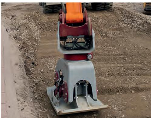
UAM Anbauverdichter mit Kontur-Adapter: Die besondere Form des Werkzeugadapters schützt alle darin befindlichen Hydraulikkomponenten. Schläuche, Öl-Verteiler und Frequenzkontroll-Anzeige können im Verbau oder schmalen Graben nicht beschädigt werden.
