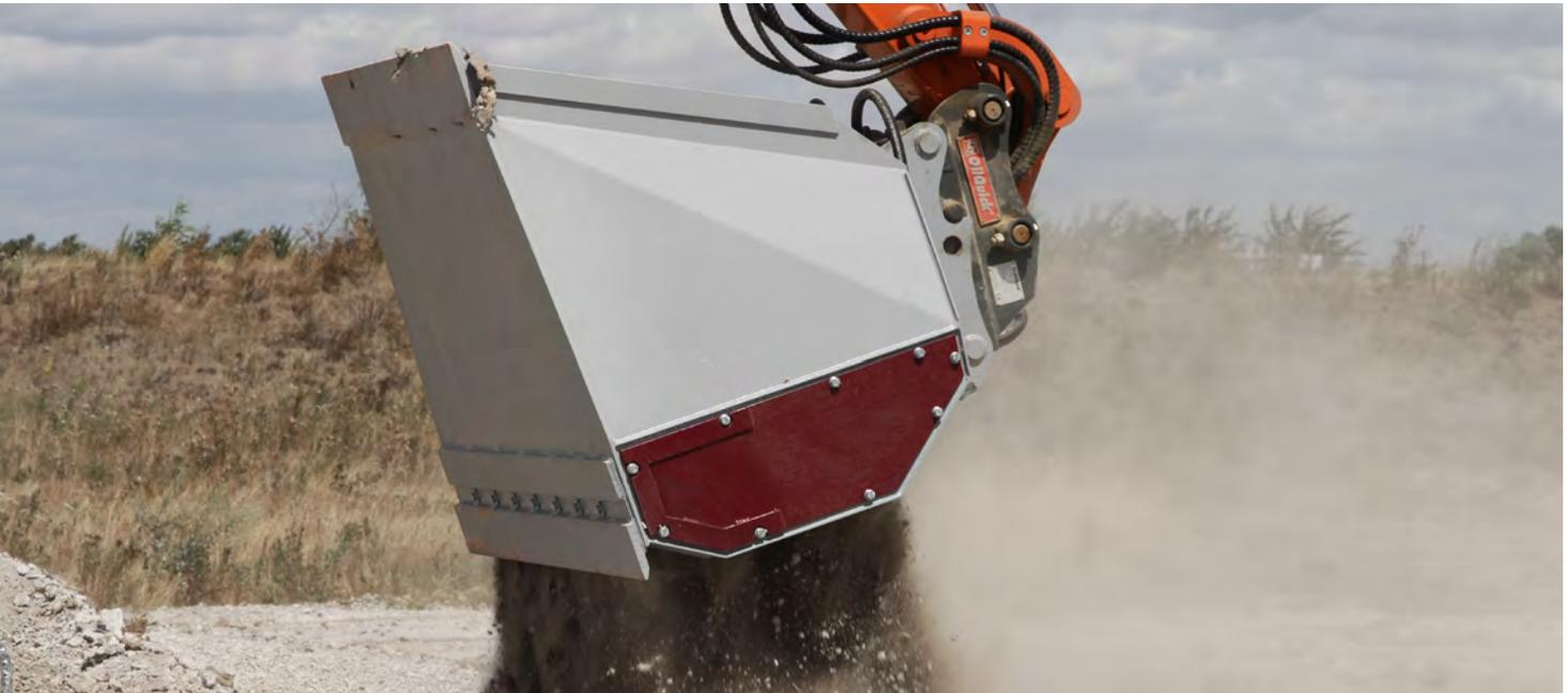
Schaufelseparatoren eignen sich ideal für Aufbereitung von Böden direkt am Einsatzort. Die mobilen Geräte sind sowohl für Radlader- als auch Baggeranbau erhältlich. Für maximalen Durchsatz können Schaufelseparatoren mit unterschiedlichen Wellenarten und Trennabständen ausgestattet werden: die Ausstattung wird optimal an die Beschaffenheit des Ausgangsmaterials und das gewünschte Ergebnis angepasst.
