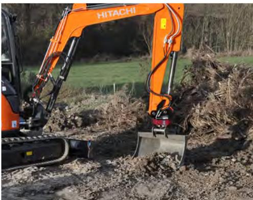
Holp Drehwerke RotoTop können vieles, was ein Tiltrotator auch kann, bei gleichzeitig geringer Bauhöhe und größtmöglicher Stabilität:
