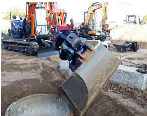
Tiltrotatoren sind das Handgelenk am Bagger und ermöglichen Arbeiten in jeder Richtung. Während Engcon EC Tiltrotatoren mit Schwenkzylinder hohe Kippmomente gewährleisten, sind Kinshofer NOX Tiltrotatoren kompakt ohne Schwenkzylinder und nahezu wartungsfrei:
