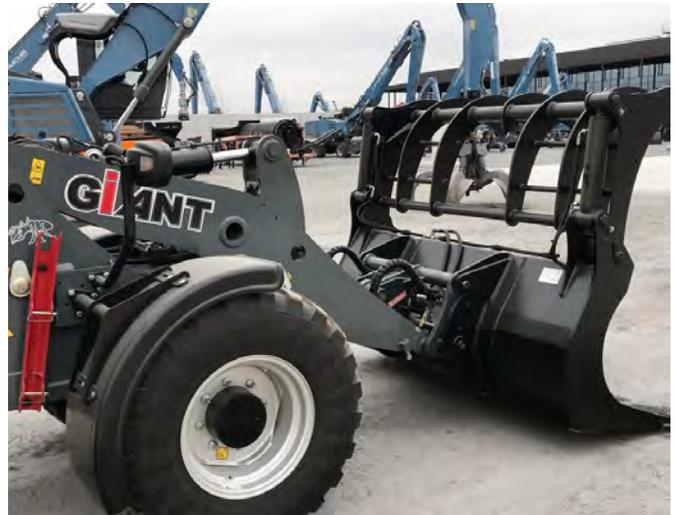
Schaufel mit Niederhalter in Sekundenschnelle angebaut
