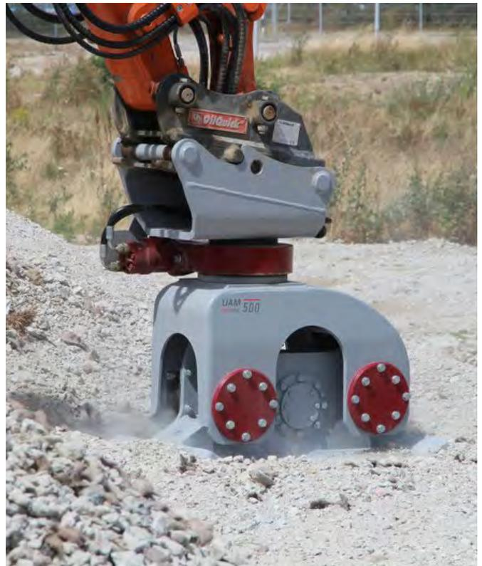
Der HD500 ist dank seiner robusten Konstruktion und seinen 500 kg Dienstgewicht für Trägergeräte ab 3 Tonnen z.B. im GaLaBau einsetzbar
