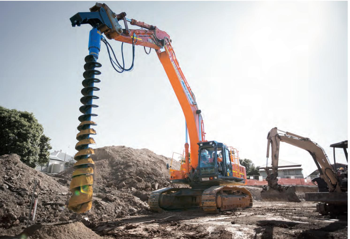
Die robusten Erdbohrer sind eine wirtschaftliche und maßgeschneiderte Lösung zum Bohren von Löchern. Ihr modularer Aufbau erlaubt die Kombination von starker Antriebseinheit, individuellem Schneckendurchmesser und einfach austauschbaren Verschleißteilen. Mit wenigen Handgriffen kann bei Bedarf am Einsatzort eine Verlängerung eingefügt werden, für noch mehr Effizienz beim Tieflochbohren.
