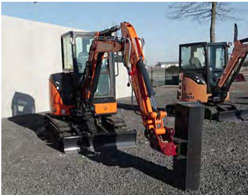
Kinshofer Schwenkmotoren TC erlauben das Schwenken aller Anbaugeräte nach links und rechts:
