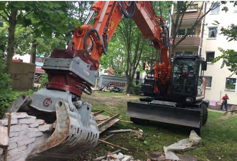
OilQuick vollhydraulischer Schnellwechsler im Materialumschlag
